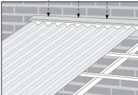
**6** Tryk tætningsprofil ind i topinddækning og pres med let hånd på topinddækningen, indtil tætningsprofillet slutter helt tæt.
