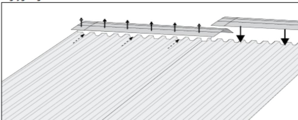
**9** Tagrygning skal overlape trapezpladen med 140-150 mm på hver side af rygningen. Montér et tætningsprofil mellem trapezplade og tagrygning. Topinddækningen fastgøres med Plastmo Topskruer ned gennem trapezplade.
