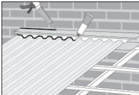
**7** Fug mellem topinddækning og mur. Fug med Plastmo Silikonefugemasse mellem tætningsliste og trapezpladen.
